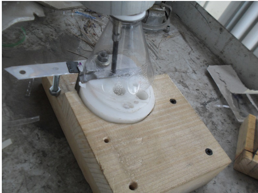
Figura 2. Dispositivo para la extracción de fibras plásticas recicladas, proveniente de botellas.
