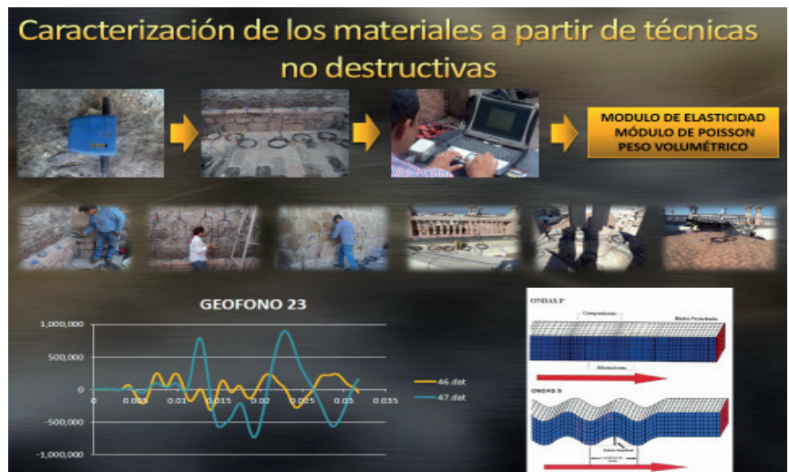
Figura 9. Generación y medición en campo de las ondas elásticas y su posterior análisis para la obtención de las propiedades mecánicas (módulo de elasticidad, relación de Poisson y peso volumétrico) de los seis sistemas constructivos del templo de San Antonio de Padua. Fuente: Elaboración a partir de Orenday (2016).
