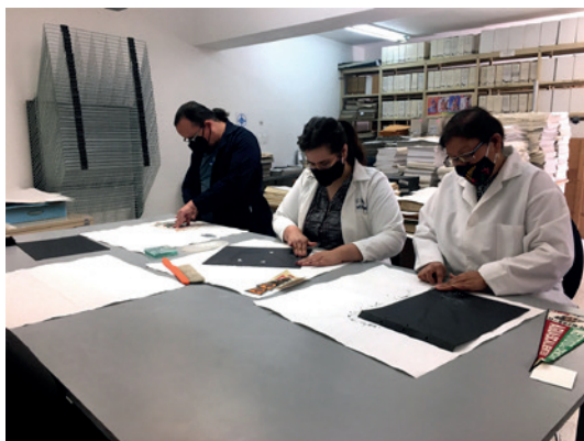
Figura 13. Limpieza mecánica de todos los elementos que componen el Álbum IACT, con ralladura de borrador blanco libre de ftalatos marca Staedtler®.
