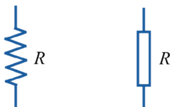
Figura 1.22. Formas de representar una resistencia eléctrica.
