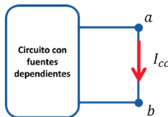
Figura 8.3. Forma de cortocircuitar las terminales a y b para calcular la corriente de corto circuito I_{cc} . Este cálculo se realiza con todas las fuentes en su estado original.
