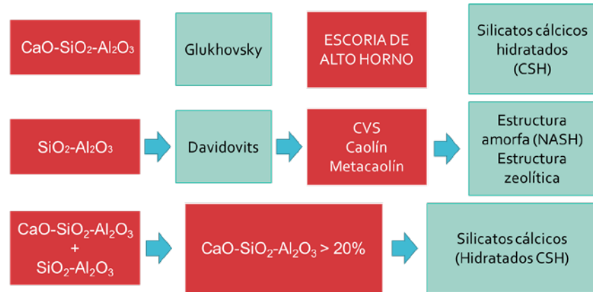
Figura 8. Tipos de activación alcalina con base en la materia prima utilizada, su composición química y el tipo de gel resultante. Elaboración propia.
